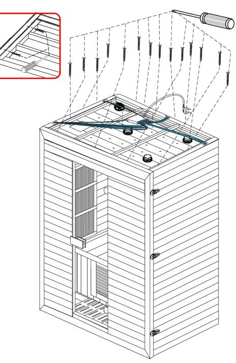
**Step 13** — **Installing the Wire Fixers**
